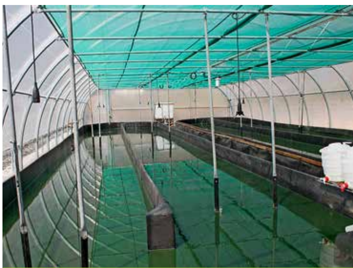
La spiruline croît dans une eau salée et alcaline dont le PH est proche de 10. En Valais, la chaleur sous serre est suffisante pour produire d'avril à octobre.
